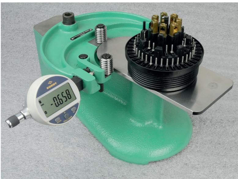
Mittels einer Gleitschiene auf einem Auflagebock findet der Prüfling auch bei kleinen Gewindesteigungen sicher den richtigen Gewindengang
