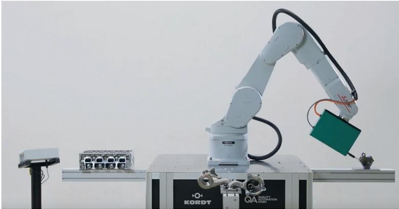
Automatische Gewinde-Prüfmaschine montiert auf einem Sechs-Achs-Roboter prüft unterschiedliche Werkstücke
