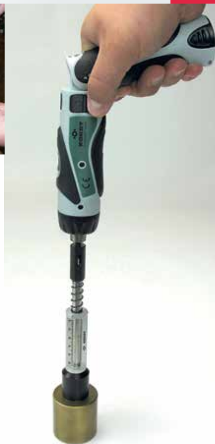
Oben: Automatische Gewindeprüfung mit Messung der Gewindetiefe (links 5319, rechts 5318)
